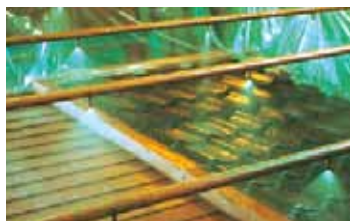
水密試験の様子 タイマルーフM型・カナメルーフ ※(財)建材試験センターでの水密試験
